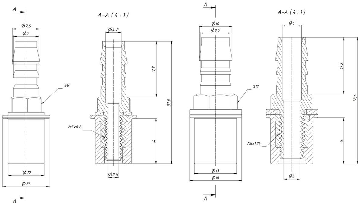
Самоуплотняющиеся фитинги R-6 и R-8/10 предназначены для соединения с канализационной трубой капиллярной трубки диаметром 6 мм и 8/10 мм.
